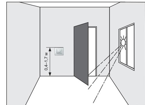
Рисунок 1. Монтаж терморегулятора
